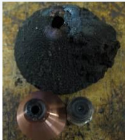
Конкурент "В" 360 А 300 пробивок (38 мм / 1.5") Хотя предназначено для 50 мм (2")
