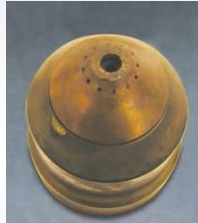
Конкурент "С" 400 А 300 пробивок (50 мм / 2")
