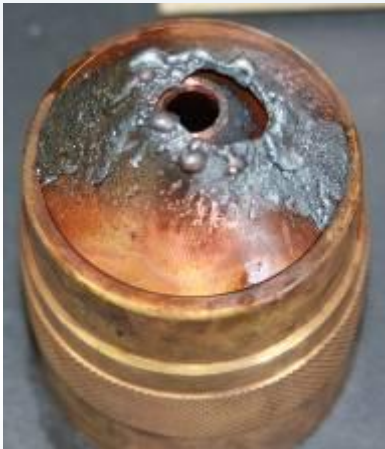
Конкурент "А" 400 А 41 пробивка (44 мм / 1.75") Хотя предназначено для 50 мм (2")
