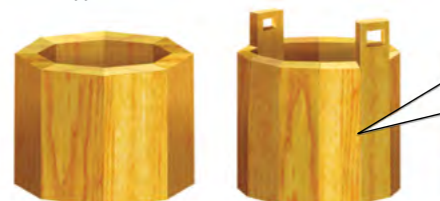
Фреза с углом обработки 22,5° Получение изделия восьмиугольного сечения
