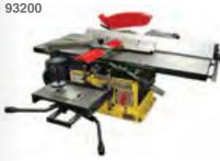
Функции станка: распиловка, строгание, сверление. В режиме сверления заготовка крепится на рабочий стол, перемещаемый по трем осям. При распиловке используется подвижная каретка с прижимной струбциной и транспортирным упором. Предусмотрено подключение пылесоса.
