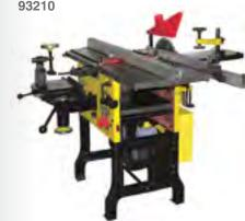
Функции станка: распиловка, строгание, рейсмус, сверлильно-долбежные операции, выборка пазов и снятие фасок насадными фрезами, заточка строгальных ножей. В режиме сверления заготовка крепится на рабочий стол, перемещаемый по трем осям. При распиловке используется подвижная каретка с прижимной струбциной и транспортирным упором.
