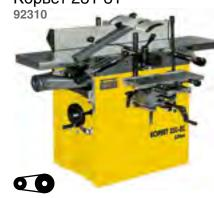
Жесткие и идеально точные рабочие столы имеют достаточно большую длину, что способствует выравниванию базовой поверхности заготовки. Четыре ножа на рабочем валу. Оригинальный механизм перемещения рабочего стола (режим рейсмуса) имеет повышенную надежность и фиксацию положения по высоте. В режиме строгания предусмотрено отключение протяжных роликов. Функция сверления и пазования.
