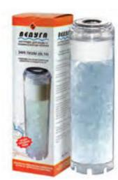
Картридж для воды 10" полифосфат (арт. 69361) предназначен для умягчения воды, применяемой в санитарно-технических целях. Защищает трубы, нагревательные элементы стиральных и посудомоечных машин, бойлеров, газовых колонок от коррозии и образования известковых отложений. Содержит кристаллический полифосфат натрия. Срок службы около 1 года (зависит от содержания солей жесткости в исходной воде). После истечения срока службы картридж подлежит замене или загрузке новой порции полифосфата натрия.
