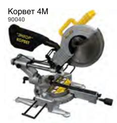
Режущий узел станка Корвет 4М перемещается по двум направляющим в подшипниках, что позволило увеличить длину реза до 305 мм. Имеется лазерный указатель для более точных распилов.
