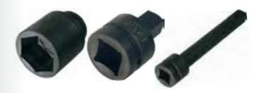
Серия торцевых ударных головок предназначена для пневматических и электрических ударных гайковёртов. Все ударные головки, переходники и удлинители изготовлены из высококачественной хромомолибденовой стали, поверхности фосфотированы марганцем, что, в сочетании со строгим соблюдением технологии, позволяет говорить о высоком качестве, особенно важном в жестких условиях эксплуатации данных изделий.
