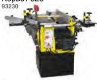
Функции станка: распиловка, строгание, рейсмус, сверление, фрезерование насадными и концевыми фрезами. Фрезерная головка и фрезерный патрон в комплекте. В режиме сверления заготовка крепится на рабочий стол, перемещаемый по трем осям. При распиловке используется подвижная каретка с прижимной струбциной и транспортирным упором. Отключаемая автоподача рейсмуса. Нижний рабочий стол имеет два удлинителя. Предусмотрено подключение пылесоса.
