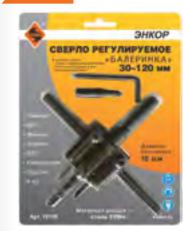
Сверло регулируемое «Балеринка» предназначено для высверливания круговых отверстий больших диаметров (30 - 120 мм) в таких материалах как ламинат, ДСП, фанера, дерево, ДВП, гипсокартон, пластик и др. В комплекте с «Балеринкой» идет шестигранный ключ для регулировки положения резцов относительно направляющего сверла и керн центрирующий. Материал резцов – сталь 65 Мп.
