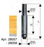
Фрезы арт. 28051 - 28055 имеют прямые твердосплавные пластины. Фрезы арт. 28057 - 28059 имеют спиральные твердосплавные пластины.
